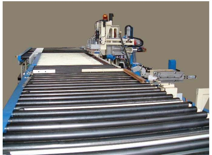
Vue d'ensemble du système d'amenage et de transfert des pièces par rouleaux motorisés. Les cadres arrivent automatiquement d'un ficheuse automatique. Les pièces unitaires sont posés directement par l'opérateur sur la table machine.
