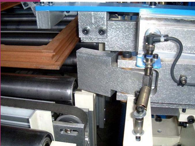
Système de mesure des pièces et cadres en entrée de machine. Ce système est monté sur la butée mobile droite. Toute pièce trop courte ou trop longue est écartée du process.
