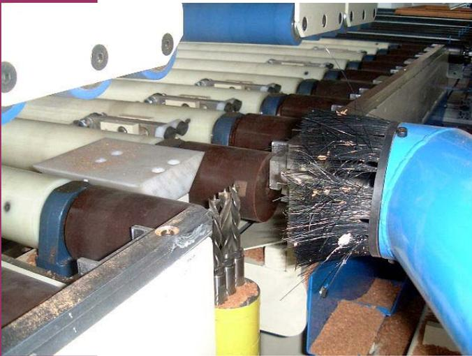
Détail du porte-outil de défonçage horizontal avec par dessous le porte-outil de perçage 3 broches pour le perçage du boîtier de crémonne. ce dernier est fixe en position. Les cadres et pièces sont positionnées par les butée droite et gauche numériques par rapport aux 3 trous. Les 2 porte-outils de défonçage sont équipés de changement rapide d'outils par cônes type HSK 50.
