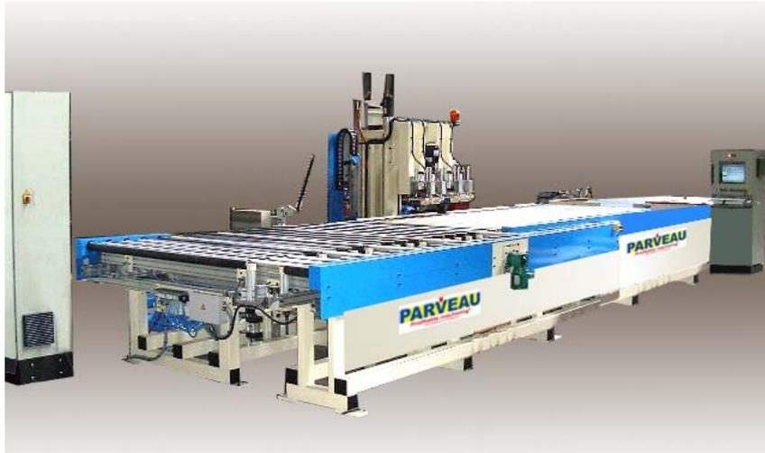
Vue d'ensemble de la ligne composée d'une butée mobile numérique à droite et d'une butée mobile numérique à gauche, un ensemble d'usinage monté sur 3 axes numériques supportant 1 unité de perçage défonçage verticale, une unité de défonçage horizontal, une unité de perçage multibroches (3 trous) par dessous fixe en position et un ensemble de tables à rouleaux motorisés.
