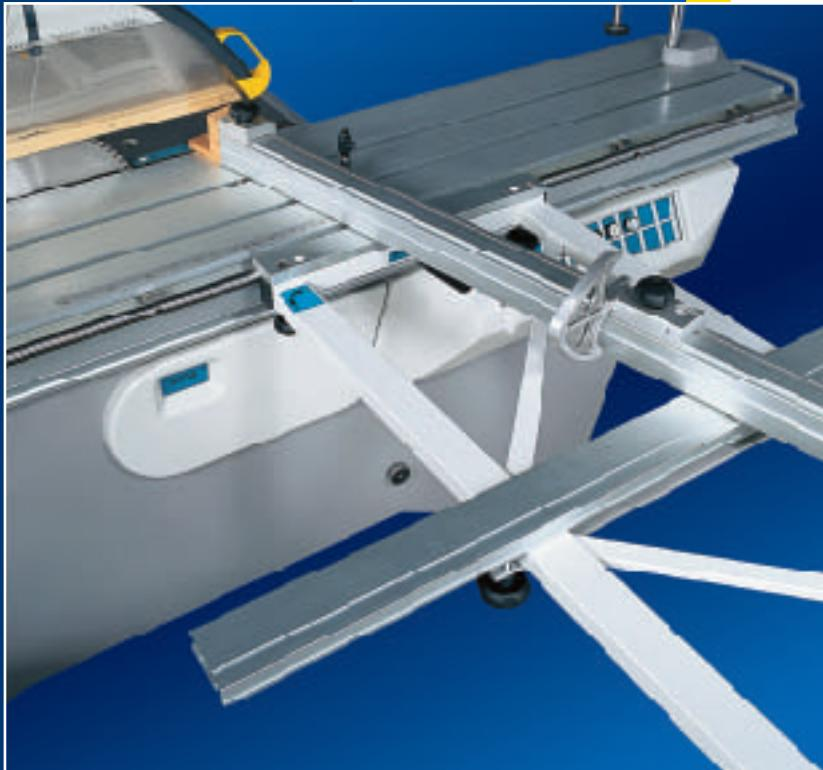
Guida telescopica per tagli inclinati  $\pm 45^\circ$  di facile e rapida regolazione (Optional). Il suo ampio dimensionamento permette un appoggio sicuro ed un taglio molto preciso. E' inoltre possibile eseguire tagli inclinati combinati inclinando sia il gruppo sega che la guida telescopica, ciò conferisce estrema versatilità alla macchina e la rende ideale per qualsiasi tipo di esigenza produttiva.
