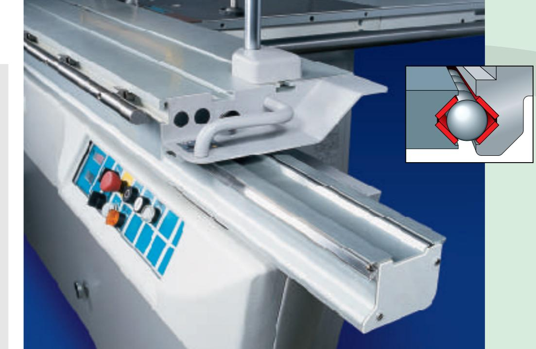
Il carrello in lega leggera di alluminio è anodizzato per evitare l'annerrimento della superficie dei pannelli in lavorazione.
