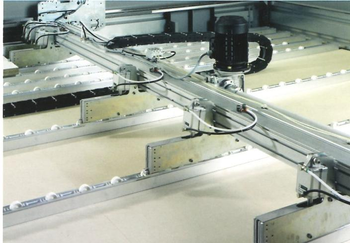
Pignons et crémaillères assurent un mouvement précis et parallèle du pousseur. Un guide de précision, sur la poutre, garantit un déplacement parfait à 90° par rapport à la ligne de découpe. Les pinces, indépendantes et auto-affleurantes, assurent un blocage parfait de la pile de pièces.
