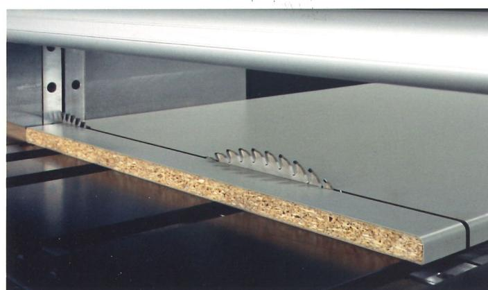
Dispositif pour la coupe de panneaux soft et post-formés. Un programme spécial du contrôle garantit une découpe parfaite aussi bien en entrée qu'en sortie de la lame, évitant ainsi que des matériaux fragiles et délicats ne soient endommagés.
