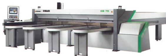
Le contrôle numérique OSI (Open Selco Interface) permet une gestion automatique des schémas de coupes, même les plus complexes, avec l'optimisation des déplacements des axes intéressés. La saillie de la lame de la pile à découper, toujours optimale, ainsi que le choix de la vitesse de coupe la plus adaptée à la hauteur de la pile et de la largeur des délignages, permet d'obtenir toujours une qualité de découpe excellente.
