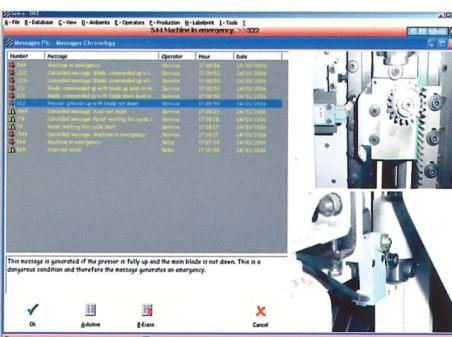
Un programme de diagnostic et de recherche des problèmes avec photos et textes permet de les résoudre rapidement et facilement.
